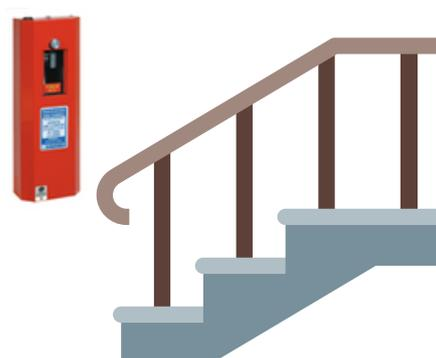
En outre, dans les habitations de la troisième famille A, l'ouverture du dispositif doit être asservie à un détecteur autonome déclencheur conforme à la norme NF S61-961
